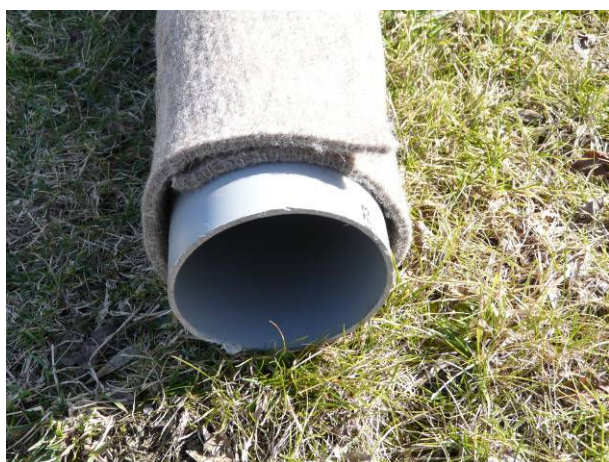
Géotextile de protection autour d'une canalisation
